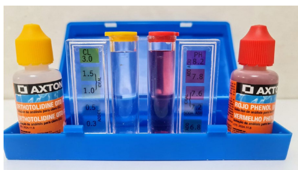
Figura 6. Material y reactivos para analizar el cloro total y el pH del agua de la piscina.
