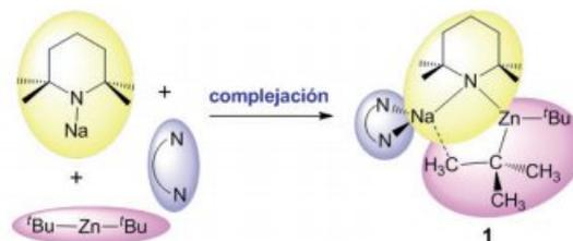
Esquema 3. Síntesis de la base bimetalica de sodio y zinc [(TMEDA)Na(TMP)Zn<sup>t</sup>Bu<sub>2</sub>] (1) mediante complejación de sus componentes monometalicos.
