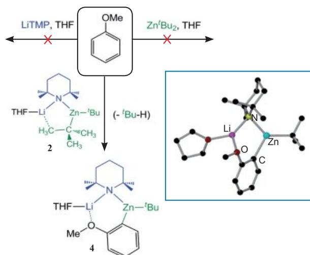
Esquema 4. AMMZn de anisol empleando la base bimetalica de Li/Zn 2 y estructura molecular de [(THF)Li(TMP)(*o*-C<sub>6</sub>H<sub>4</sub>-OMe)Zn<sup>t</sup>Bu] (4) determinada mediante difracción de Rayos X.
