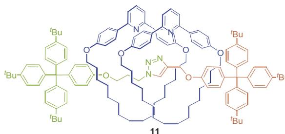
**Figura 3.** Ejemplo de [3]rotaxano con dos macrociclos y una hebra, obtenido mediante un aplantillado activo basado en reacción click de alquinos y azidas catalizada por cobre.
