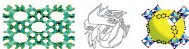
Figura 1. Estructura de una zeolita (izquierda), un carbón activado (centro) y un material híbrido metal-orgánico-MOF (derecha).
