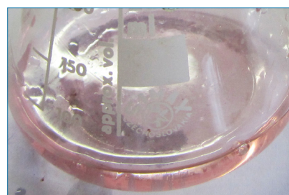
Figura 9. La disolución de \text{Fe}^{2+} poco antes de llegar al punto de equivalencia (arriba) y cuando se ha alcanzado
