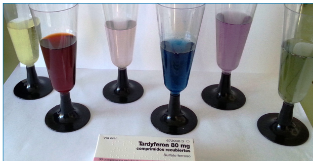
Figura 11. Copas con los complejos formados en las distintas propuestas experimentales. A la izquierda se ha incluido la “disolución amarilla” de partida para las demás
