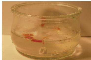
**Figura 2.** Separación de plásticos en disolución acuosa de densidad 1,2 g cm<sup>-3</sup> fondo PVC (blanco); superficie PS (rojo).
