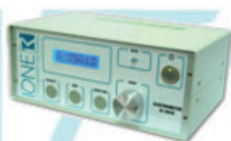
EL-5010: Electrómetro de uso general.
