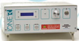
HV-7010 •Fuente DC de \pm 10KV •Rizado: 0.001% pp •Programable •Salida USB/RS485/Zig-bee
