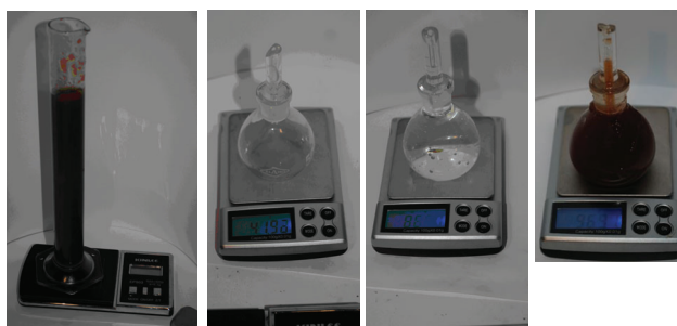
Figura 8. Medida de la densidad de la mermelada, de modo sencillo, y usando el picnómetro
