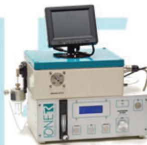
Generación de nanopartículas e iones moleculares a partir de dispersiones y soluciones.
