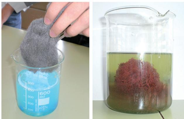
**Figura 8.** En la fotografía de la izquierda se introduce el estropajo de acero en una disolución de sulfato de cobre (II), produciéndose cambios en el color del sólido, como se observa en la fotografía de la derecha.
