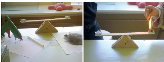
**Figura 1.** Tras colocar en una balanza un trozo de plastilina y otro de estropajo de acero en equilibrio (izquierda), se quema el acero (derecha) y se desequilibra la balanza por el aumento de peso al formarse óxido de hierro.
