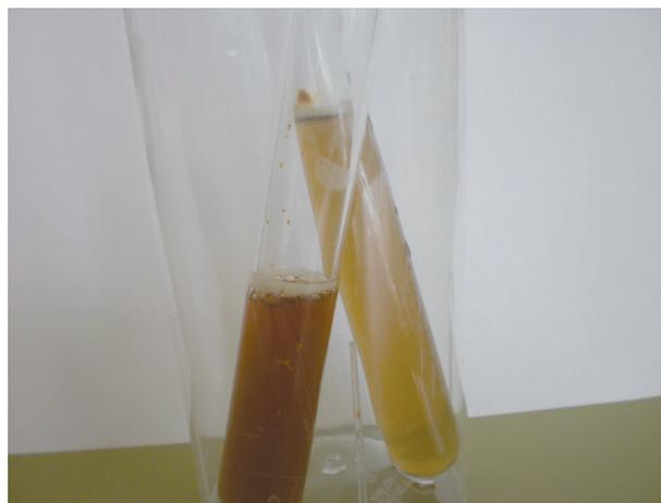
**Figura 16.** Tubo de ensayo con un poco de café de sobre con agua (derecha) y la misma disolución de café con disolución férrica (izquierda). Se observa una intensificación del color.
