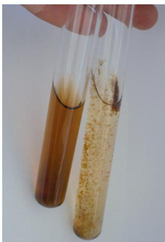
**Figura 18.** Bebida de cola calentada (izquierda) y la misma bebida de cola con disolución férrica (derecha). Se observa cómo la disolución se decolora y precipita muy lentamente el fosfato de hierro (III).
