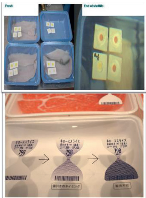
Figura 7. Alimentos frescos con marcadores basados en productos químicos que cambian del color con el pH
