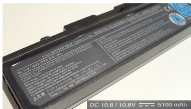
Figura 1. Fotografía de una batería de litio de ordenador portátil; en la ampliación se muestran su voltaje (10.8 V) y su capacidad de carga (5100 mA h). La masa de la batería es 0.32 kg, de lo cual se puede calcular una densidad de energía de 172 W h kg -1 . 4
