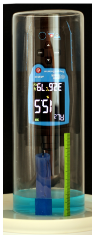
Figura 4. Experimento de la vela y el vaso adaptado para medir la fracción de oxígeno que consume la vela. El detector de oxígeno se ha colocado en posición invertida para que el sensor se encuentre cerca de la llama de la vela.
