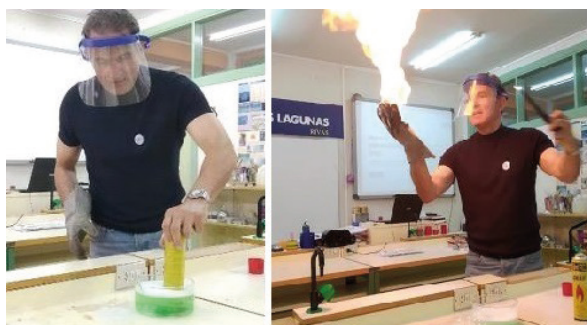
Figura 9. Obtención y combustión de espuma inflamable de isobutano.
