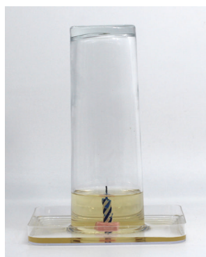
Figura 2. Tras apagarse la vela, el aire que contiene el vaso comienza a enfriarse y el agua de la cubeta asciende por el interior del vaso hasta que se equilibran las presiones interna y externa. Cuando se utiliza un vaso cilíndrico y una vela delgada como los de la figura, el agua que entra al vaso ocupa entre un 20 % y un 25 % de la capacidad del vaso. El volumen de agua que entra al vaso ( \approx 80 \text{ cm}^3 ) es mucho mayor que el volumen ocupado por la vela y su base ( \approx 2 \text{ cm}^3 ).
