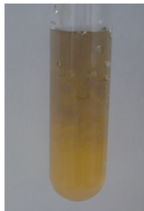
Figura 12. Fotografía donde se observa el oscurecimiento de la disolución de vitamina C al caer las gotas de la solución férrica.
