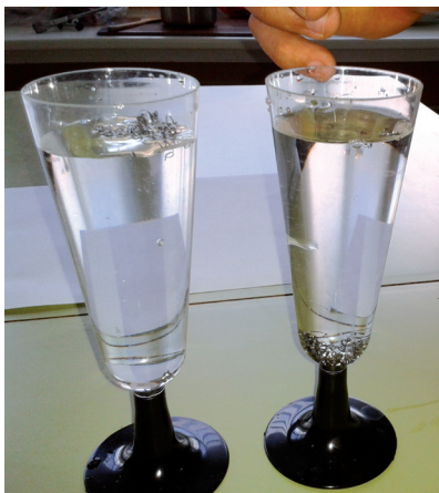
Figura 7. En la copa izquierda se observan las virutas de estropajo de acero en la superficie del agua. En la de la derecha, una vez añadido el detergente, las virutas de acero caen al fondo.
