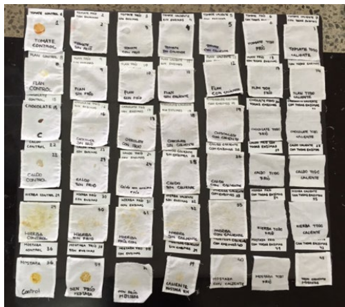
Figura 8. Muestrario de telas con manchas después de lavarlas con detergentes con y sin enzimas en frío y en caliente.
