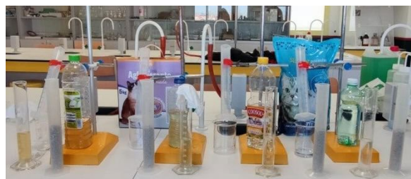
Figura 4. Materiales utilizados para analizar la capacidad de retención de la sepiolita frente a diferentes líquidos.
