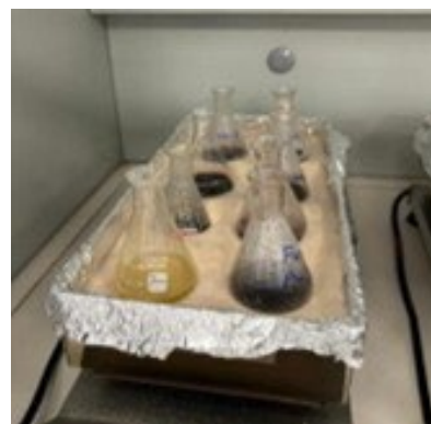
Figura 3. Calentamiento en baño de arena.
