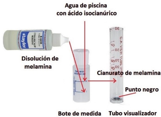
Figura 11. Materiales y reactivo del test Taylor-ACN®.
