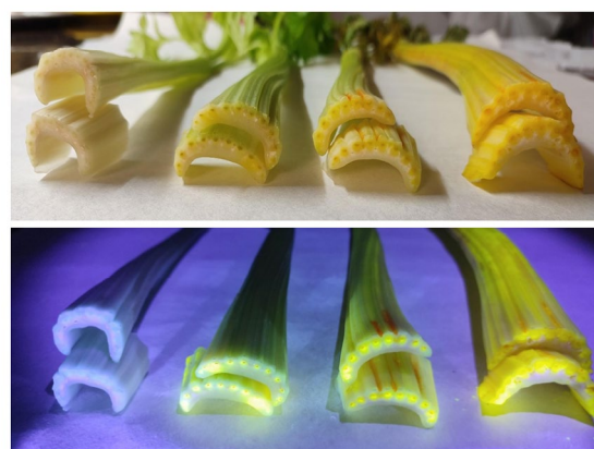
Figura 10. Fotografía de los cortes transversales de los tallos de cada rama de apio utilizada. Arriba sin iluminar, abajo iluminadas con luz ultravioleta, después de extraerlas de sus recipientes a las 48 horas de haber sido introducidas en agua y disoluciones de fluoresceína sódica de concentraciones 0,005%, 0,05% y 0,5% en masa respectivamente.
