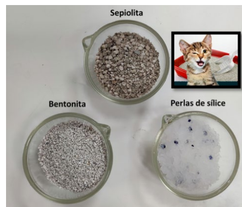
Figura 3. Lechos de gatos analizados: sepiolita (centro), perlas de sílice (izquierda) y bentonita (derecha).
