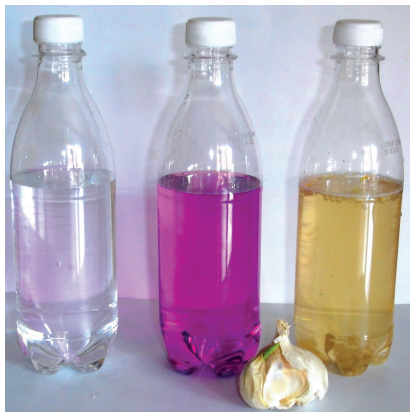
Figura 14. Botellas (de izquierda a derecha) con agua, disolución acuosa de \text{KMnO}_4 y la misma disolución tras ser reducida con ajo.
