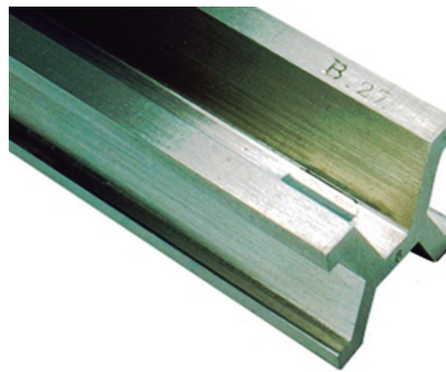
Figura 3. Reproducción del patrón de metro que se conserva en la Oficina Internacional de Pesas y Medidas de Sèvres, cerca de París.
