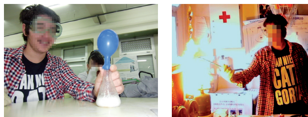
Figura 6. Obtención del acetileno en globo (izqda.) y posterior explosión del gas a presión contenido en el interior del globo (dcha.).
