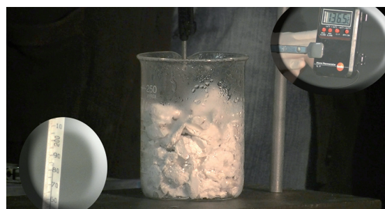
Figura 10. Reacción entre el óxido de calcio y el agua y medida del aumento de temperatura.
