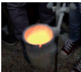
Figura 16. Presenciando el desarrollo y el resultado final de una aluminotermia.
