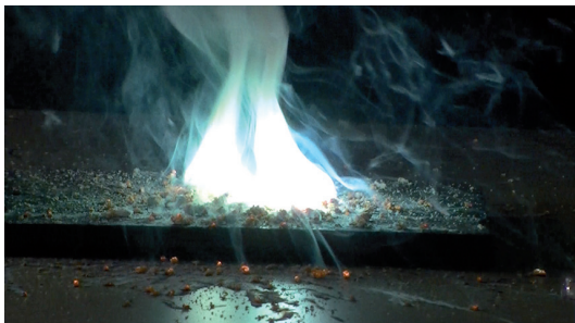
Figura 6. Síntesis del sulfuro de zinc después de poner en contacto los elementos constituyentes con una varilla de vidrio caliente.
