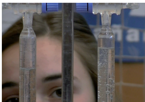
Figura 5. Proporción volumétrica para los gases obtenidos mediante la electrolisis del agua observada por una estudiante.
