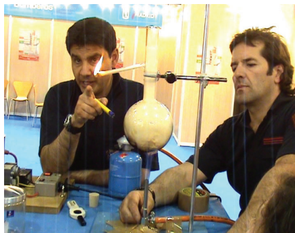
Figura 1. Destilación seca de la madera realizada por bomberos del Ayuntamiento de Madrid durante la IX Feria Madrid es Ciencia.
