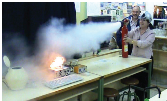
Figura 6. Descarga de dióxido de carbono frente a fuego simulado de tipo eléctrico en el laboratorio.
