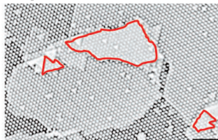
Figura 2. Imagen de transmisión electrónica de alta resolución (HRTEM) de monocapas de nitruro de boro (señaladas en rojo).
