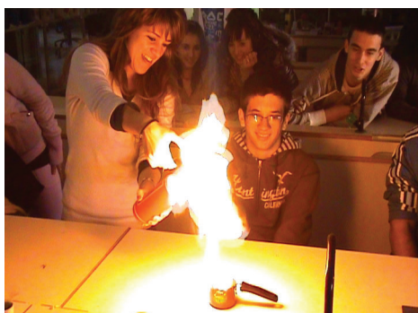
Figura 3. Expansión de las llamas al añadir agua a un fuego de heptano que simula al típico de aceite inflamado en una sartén.
