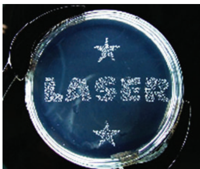
Figura 1. Pulsos cortos de luz visible o infrarroja permiten controlar espacio-temporalmente el crecimiento de cristales de KCl en un gel de agarosa.
