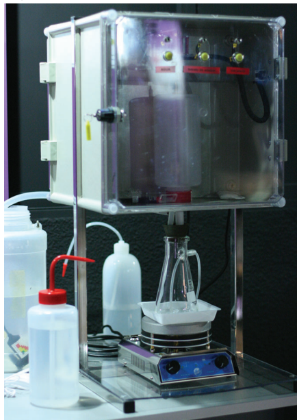
Figura 4. Máquina para dosificar la adición de cloruro de litio y agua.
