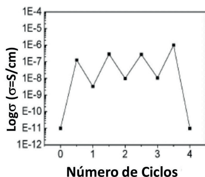
Figura 9. Respuesta eléctrica del polímero [CuI(ANP)] n a distintos ciclos de ácido acético a 25°C
