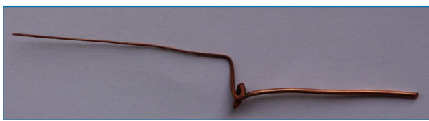
Figura 7. Fragmento de un cable de cobre que se ha usado varias veces como ánodo. Obsérvese la diferencia entre el grosor de la parte del electrodo que ha quedado dentro (izquierda) y fuera (derecha) de la celda electrolítica
