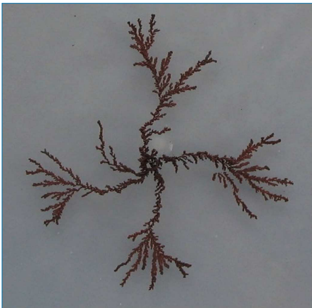
Figura 8. Depósito electrolítico obtenido situando un imán de neodimio bajo la placa petri, con su campo magnético orientado perpendicularmente a la superficie de la placa petri (debajo de la cual se halla). Puede comprobarse cómo en el crecimiento del depósito electrolítico subyace una desviación en el sentido horario
