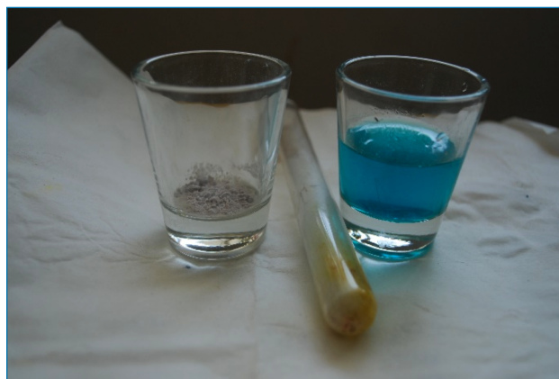
Figura 4. Se muestra el resultado del experimento descrito, a la izquierda se muestra el sulfato deshidratado y a la derecha como al disolverse de nuevo el sulfato recupera el color azul. En el tubo donde se realizó la prueba se ve la leve tonalidad amarilla, debida al azufre resultante de la descomposición del sulfato. La cantidad es irrelevante
