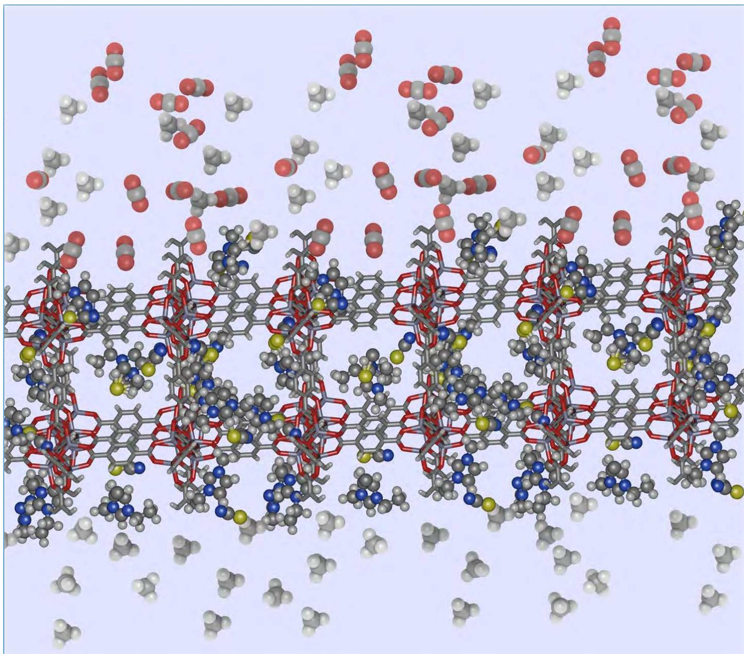
Cristales porosos impregnados con líquidos iónicos para captura y separación de dióxido de carbono,
