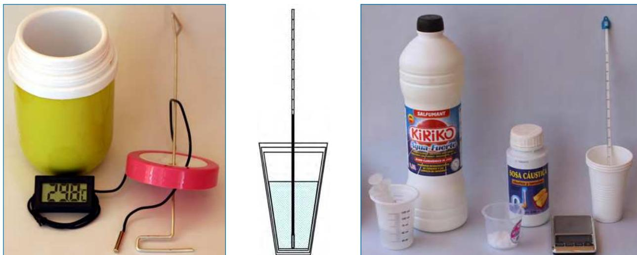
**Figura 7.** *Izqda.*: Calorímetro construido con un pequeño termo, un termómetro de acuario y una varilla. *Centro.*: Para efectuar una medida rápida, se puede sustituir el termo por un conjunto de tres vasos de plástico, encajados uno dentro de otro, ya que el calor intercambiado con la atmósfera es despreciable si el proceso de disolución es rápido. *Dcha.*: Materiales para medir la entalpía de neutralización del ácido clorhídrico con hidróxido sódico
