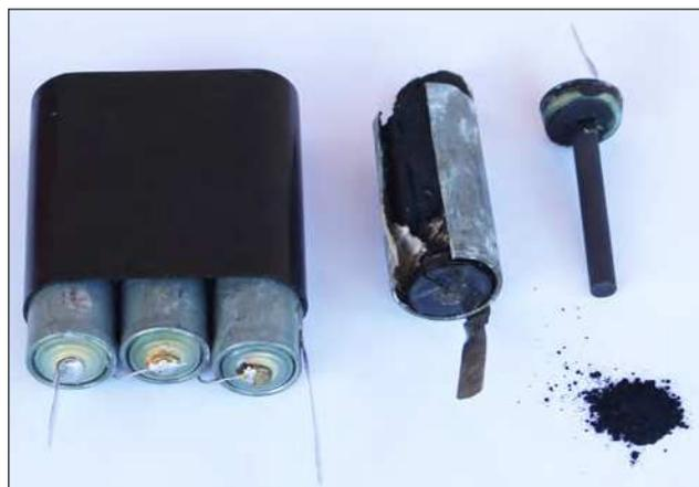
**Figura 5.** El dióxido de manganeso es uno de los componentes de la pasta negra que rodea al electrodo central de grafito de una pila ordinaria
