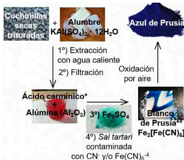
Esquema 4. Síntesis original del Azul de Prusia realizada por Diesbach en el laboratorio de Dippel en Berlín en 1706. *Disolución acuosa de E-120. **Mezcla acrílica de Blanco de Prusia y Azul de Prusia
