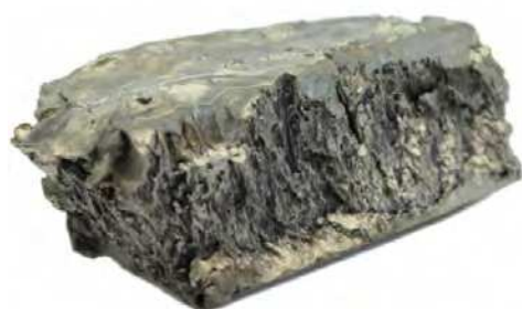
Figura 1. Muestra de terbio metálico de 235 g de alta pureza (99,9 %) [3]
