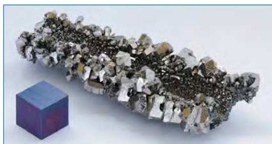
Figura 1. Cristales de niobio de alta pureza (99,995 %) formados por electrolisis, al lado de un cubo de 1 cm 3 de alta pureza (99,995 %) de niobio anodizado ( https://bit.ly/2t05AL4 , visitada el 04/03/2019)
