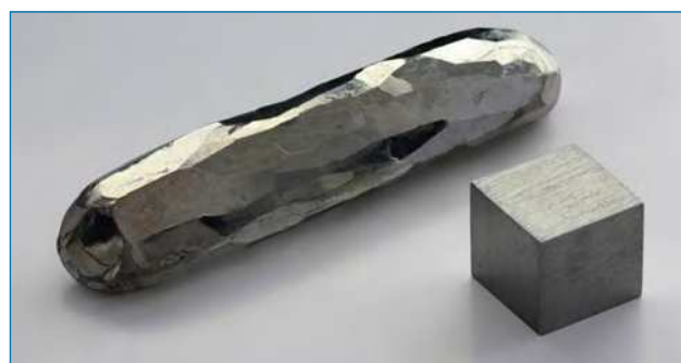
Figura 1. Una barra de cristal de cadmio (pureza 99,999 %) obtenida por el proceso de flujo y un cubo de 1 cm 3 de cadmio [1]
