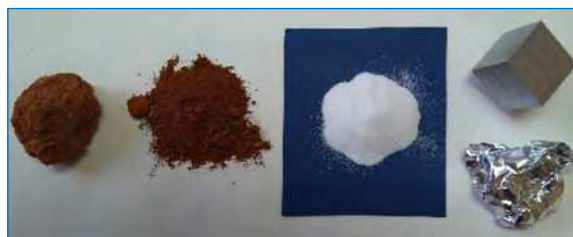
Figura 1. De izquierda a derecha: Bauxita original y molida, alúmina (blanca), y Al (cubo de 2,5 cm de lado y muestra de “papel” de aluminio). Fotografía tomada por G. Pinto de muestras donadas por el Grupo Alcoa España en 2010 a la E.T.S. Ingenieros Industriales (Universidad Politécnica de Madrid)
