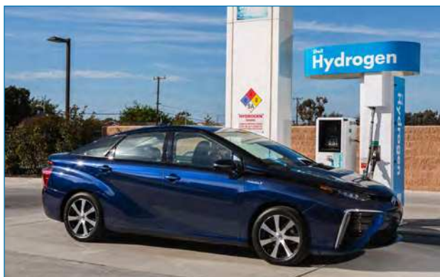
Figura 1. Estación de servicio de hidrógeno (denominada popularmente hidrogenera), junto con un vehículo eléctrico de pila de combustible y depósito de hidrógeno a presión (fotografía cedida por Toyota)
