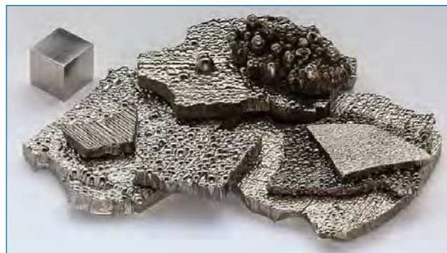
Figura 1. Algunos fragmentos de cobalto puro (99,9%) refinado por electrólisis, junto a un cubo de 1 cm 3 de cobalto de alta pureza (99,8% = 2N8) para comparar (Fotografía de Alchemist-hp, https://bit.ly/2RZB0B5 , visitada el 13/01/2019)
