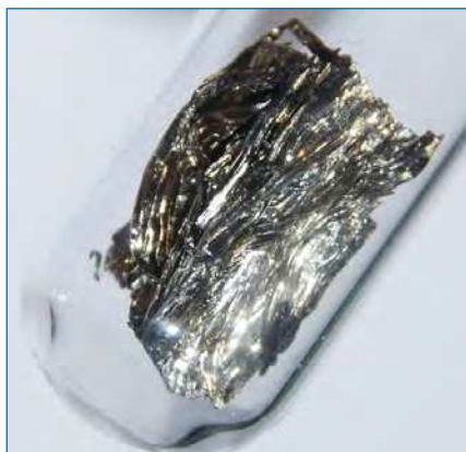
Figura 1. Muestra de samario metálico conservada en atmósfera inerte en una ampolla de vidrio [3]
