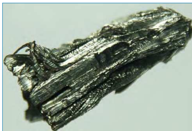
Figura 1. Disprosio dendrítico ultrapuro [4]
