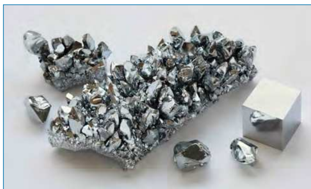
Figura 1. Cristales de cromo producidos por descomposición de yoduros de cromo (pureza 99,999 %) y cubo de cromo de 1 cm 3 de alta pureza (99,999 %) para su comparación [4]
