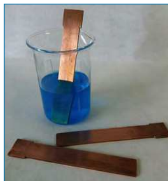
Figura 1. Electrodo de cobre en disolución de CuSO 4 (Laboratorio de Química, Escuela de Ingeniería de Bilbao)
