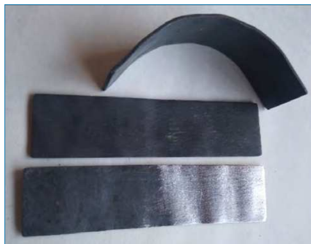
Figura 1. Láminas de plomo. La situada en la parte superior de la imagen ha sido doblada (con la mano) para mostrar la gran plasticidad del metal. La situada en la parte inferior ha sido lijada en su mitad derecha para mostrar el brillo metálico. Fotografía del autor
