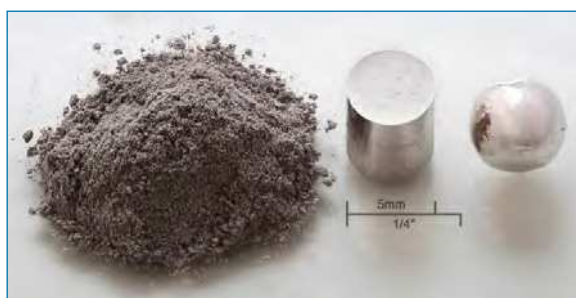
Figura 1. Un gramo del elemento químico rodio en diversas formas: polvo, cilindro obtenido por presión, bola refundida obtenida bajo argón usando un arco eléctrico. Fotografía: Alchemist-hp (www.pse-mendeleejew.de, visitada el 06/02/2019)
