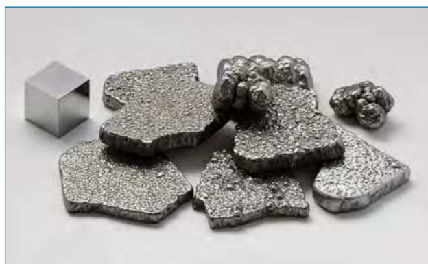
Figura 1. Hierro de alta pureza (más de 99,97 %) refinado electrolíticamente y un cubo de hierro de alta pureza de 1 cm de lado [4]
