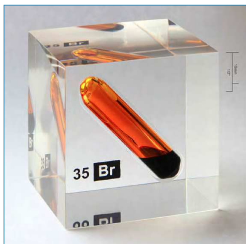
Figura 1. Vial de bromo líquido en equilibrio con su fase gas dentro de un recipiente de metacrilato [3]
