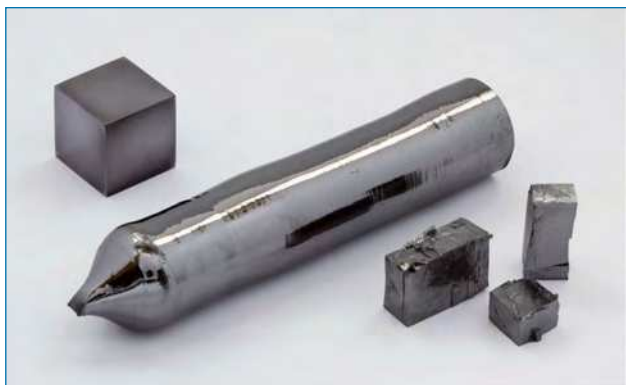
Figura 1. Cristal de tántalo de elevada pureza (99,999 %) preparado mediante el método de zona flotante, fragmentos cristalinicos y cubo de 1 cm 3 (99,99 % = 4N) para su comparación [5]
