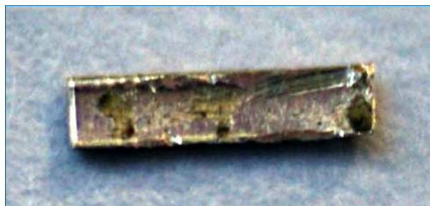
Figura 1. Radio-226 electrodepositado sobre lámina de cobre y recubierto con poliuretano para evitar la oxidación [7]
