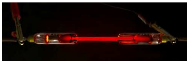
Figura 1. Tubo de descarga de neón [4]
