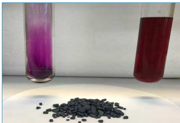
Figura 1. Yodo: vapor característico, yodo cristalino y solución de yodo en diclorometano. Composición del autor
