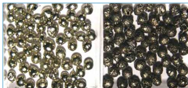
Figura 1. Estaño de alta pureza (99,999 %) en sus formas alotrópicas β (estaño blanco, izq.) y α (estaño gris, der.) [3]
