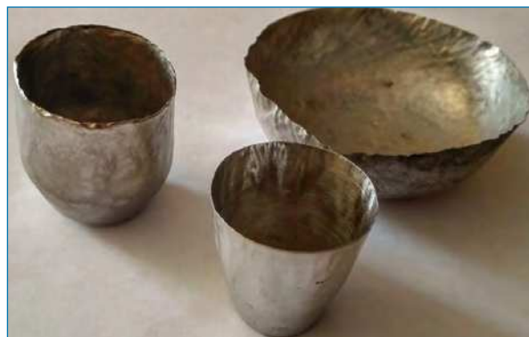
Figura 2. Crisoles y cápsula de Pt fotografiados por el profesor Adolfo Narros en la E.T.S. de Ingenieros Industriales (UPM)
