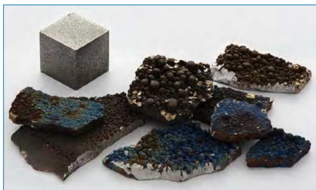
Figura 1. Fragmentos de Mn puro (99,99 %) refinado electrolíticamente, con el aspecto típico de una superficie oxidada por el aire, así como un cubo de 1 cm 3 de Mn de alta pureza (99,99 %), para comparar [https://bit.ly/2TEd7Le, visitada el 12/03/2019]
