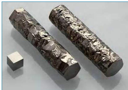
Figura 1. Barras de circonio puro del 99,97 % ( crystal-bar ) mostrando diferentes texturas y obtenidas por el método Arkel-de Boer (descomposición de yoduro) y un cubo de 1 cm 3 de circonio de 99,95 % de pureza [4]
