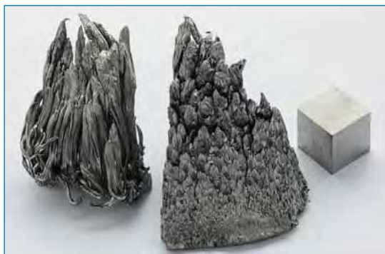
Figura 1. Dos muestras de itrio dendrítico sublimado y cubo de itrio de 1 cm 3 de alta pureza [3]
