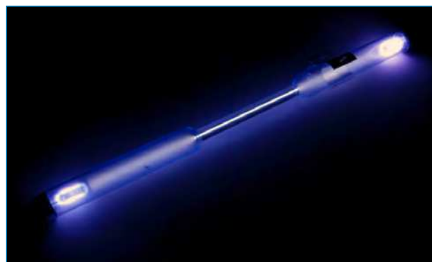
Figura 1. Tubo de descarga lleno de Xe puro [5]
