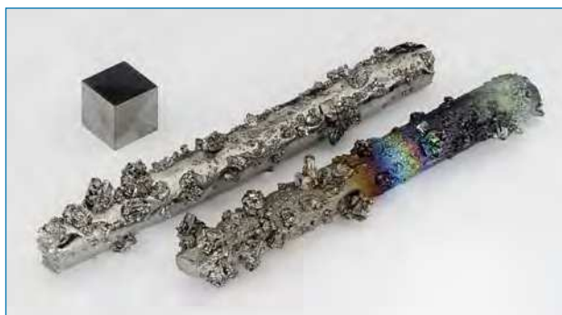
Figura 1. Varillas de wolframio con cristales evaporados, parcialmente oxidadas (pureza 99,98 %) y cubo de wolframio de 1 cm 3 de alta pureza (99,999 %) para su comparación [3]
