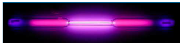
Figura 2. Tubo de descarga relleno de argón. https://pse-mendelejew.de/argon/
