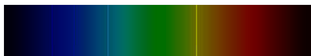
Figura 1. Tubo de descarga conteniendo He, 1,8 kV, 18 mA junto al espectro del He con su característica línea amarilla
