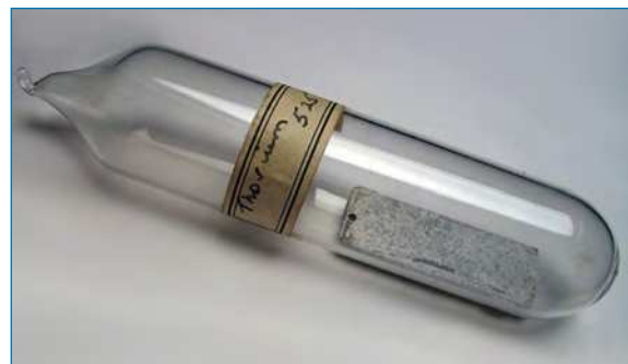
Figura 1. Metal torio mostrando signos de corrosión
