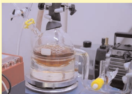
Figura 1. a) Esquema del equipo utilizado por S. L. Miller, en 1953, en su primer experimento de síntesis de aminoácidos en las supuestas condiciones prebióticas de la Tierra primitiva. b) Disolución rojiza obtenida tras una semana de descargas eléctricas sobre una mezcla de gases ( \text{CH}_4 + \text{NH}_3 + \text{H}_2 + \text{H}_2\text{O} ) en condiciones similares a las utilizadas por S. L. Miller en 1953.
