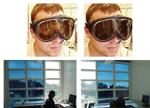
Figura 5. (superior) Dispositivo electrocrómico flexible de transmisión variable integrado en un sistema de visión desarrollado por los grupos del Pr. G.A. Sotzing (Institute of Materials Science, UCONN) y Pr. T.F. Otero (Centro de Electroquímica y Materiales Inteligentes, UPCT) (inferior) Ventana inteligente desarrollada por la compañía SAGE.
