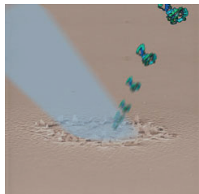
Figura 6. Ilustración en la que se muestra una imagen de la superficie empleada en la técnica NIMS, y la correspondiente desintegración de la misma tras irradiación láser.
