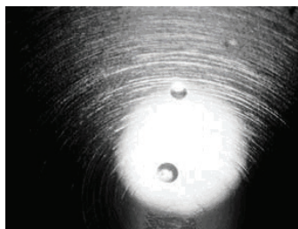
Figura 8. Marcas sobre la superficie de aluminio originadas por el impacto de una bola de acero al caer.
