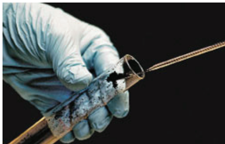
Figura 7. Los nanotubos de carbono de pared gruesa (MWNTs) con una longitud superior a los 20 \mu\text{m} , muestran una toxicidad similar a la del asbesto.
