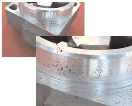
Figura 12. Poros de hidrógeno detectados en una pieza de aluminio fundido.
