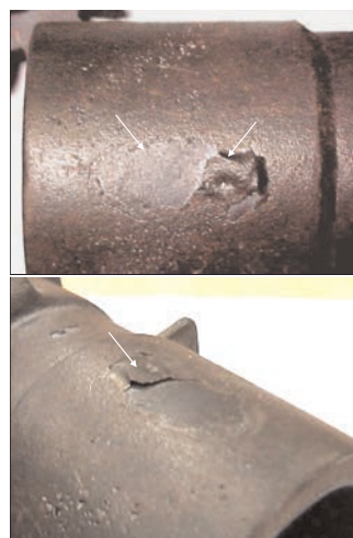
Figura 15. Sopladura deformada por la presión del metal líquido durante la colada.
