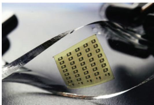
Figura 4. Fotografía de un circuito de silicio integrado dentro de un plástico flexible y transparente.
