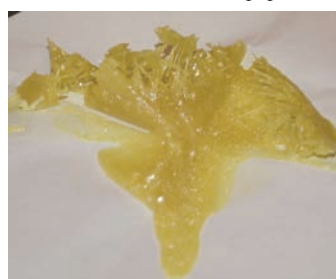
Figura 2. Cristales aciculares de azufre.
