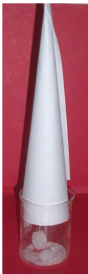
Figura 3. Cono de papel para recoger los cristales de naftalina.
