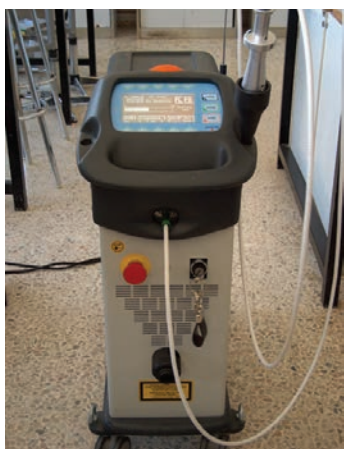
Figura 1. Láser SFR-Nd:YAG 1064 nm portátil y con fibra óptica, modelo comercial de El. En.
