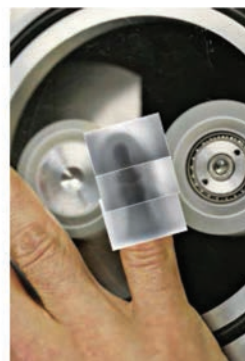
Figura 9. Con una máquina capaz de despegar cinta adhesiva es posible obtener una imagen de rayos X de un dedo.
