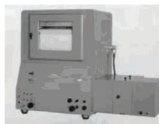
Figura 4. Cari 14, primer espectrómetro comercial UV/vis/NIR. Se comenzó a comercializar en 1954.
