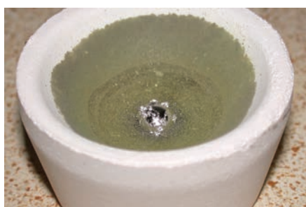
Figura 8. Detalle de una copela después de su empleo para el refinado de plata en los laboratorios del Instituto de Arqueología de Londres. En el centro hay una pequeña bolita de plata pura. Por debajo, la copela de cenizas de hueso ha absorbido los óxidos de plomo y cobre, adquiriendo así un color verdoso. Compárese esta imagen con la ilustración de una copela en el emblema de Basilio Valentín reproducido en la Figura 2.
