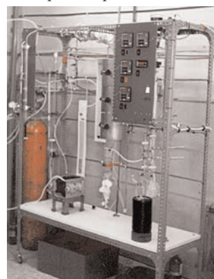
Figura 1. Equipo artesanal de reacción catalítica empleado en el ICP en la década de los años 1980.
