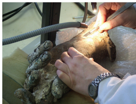
Figura 3. Ejemplo de limpieza mecánica con bisturí bajo binocular. El objeto es una mano de bronce de época romana. Ver caso práctico V.
