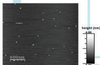
Imagen AFM de nanopartículas de Fe_3O_4 (4nm) depositadas por electro spray (cortesía de F Briones IMM-CSIC)
