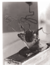
Figura 1. Primer transistor de Ge inventado en 1947 por Bardeen, Shockley y Brattain. Cortesía de Lucent Technologies Bell Laboratories .
