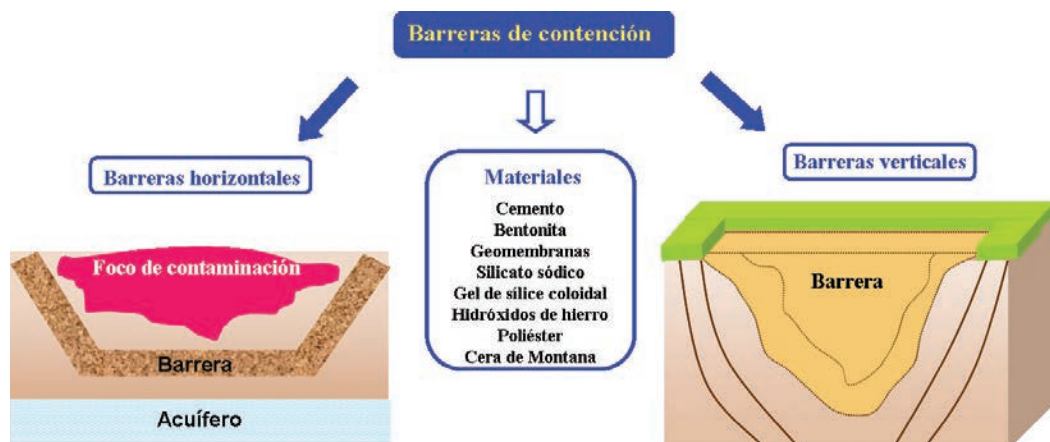
Figura 6. Disposición de las barreras de contención.
