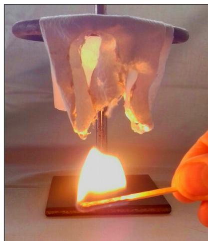
**Figura 16.** Comprobación de la incombustibilidad de un filtro
