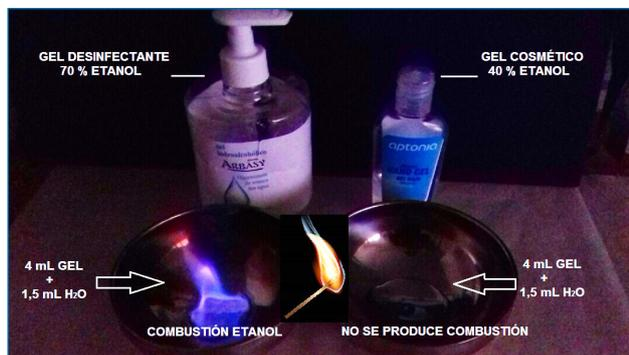
Figura 10. Prueba de combustión de hidrogeles alcohólicos
