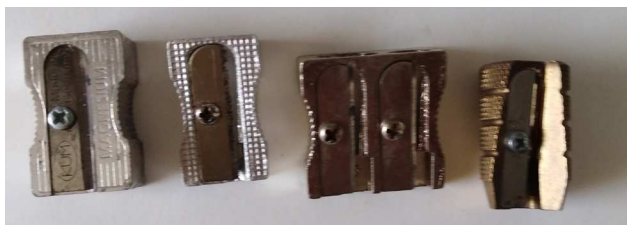
Figura 10. Pequeña colección de sacapuntas metálicos. De izquierda a derecha: de magnesio, de aluminio, de zinc y de latón.
