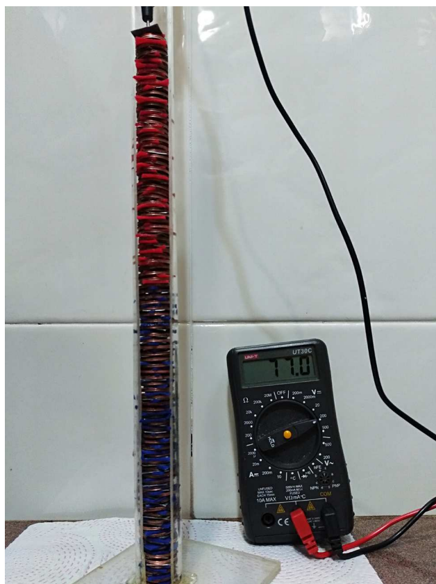
Figura 8B. Pila de Volta con 100 monedas de 2 céntimos de euro y los correspondientes fieltros y trozos de zinc. Los fieltros se han mojado con agua salada. La columna mide 30 cm. Voltaje obtenido: 77 V. La intensidad es muy pequeña, del orden de 31 mA
