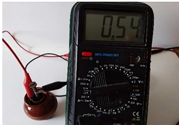
Figura 4. Se llena el espacio entre el tubo de cobre y el clavo de hierro con vinagre y se conectan los electrodos a un voltímetro. En los primeros instantes, la diferencia de potencial es de 0,54 V. Al cabo de unos minutos sube a 0,60 V.
