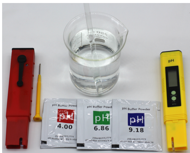
Figura 3. El medidor de la izquierda se calibra girando el potenciómetro, que lleva en la parte superior trasera, con un destornillador. El de la derecha se calibra automáticamente (reconoce el pH de dos tampones de calibrado).
