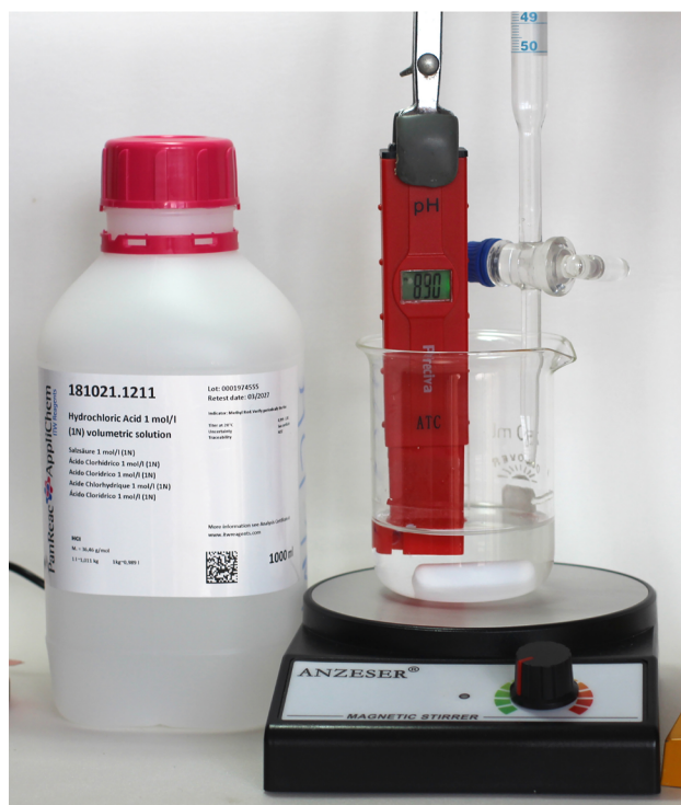
Figura 4. Montaje experimental para registrar la variación del pH a medida que, desde la bureta, se añade el valorante a la disolución problema.
