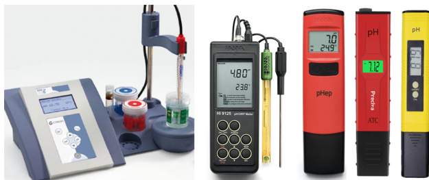
Figura 1. Izquierda: Medidor de pH de sobremesa para laboratorio. Centro: Equipo portátil para trabajo de campo. Derecha: Tres modelos de medidores de pH de bajo coste.
