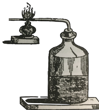
Figura 3. Ilustración del método de Marsh usado por Orfila para determinar la presencia de arsénico. [18]
