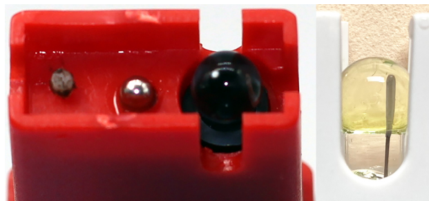
Figura 2. Izquierda. Imagen en detalle de un medidor de pH no profesional, de izquierda a derecha: electrodo de referencia, sensor de temperatura y electrodo de vidrio. Derecha. Detalle del bulbo del electrodo de vidrio, en cuyo interior hay una disolución de pH constante y un alambre de plata que conecta el electrodo de vidrio al circuito del medidor.
